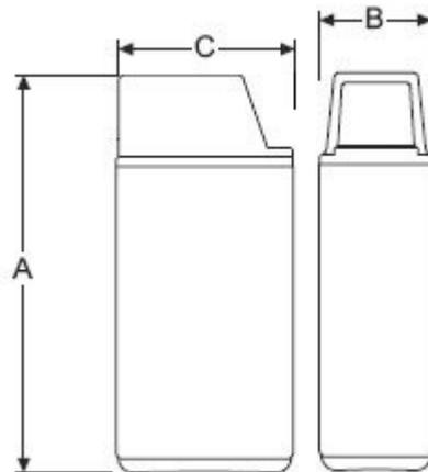
Abmessungen: AxBxC 1110x325x520mm
